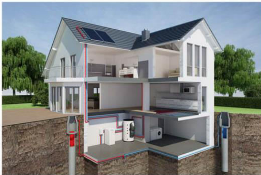
Slika 8.17: Prikazuje izkoriščanje toplote iz podtalne vode. (VIR: Varčujem z energijo, 18 December 2020)
