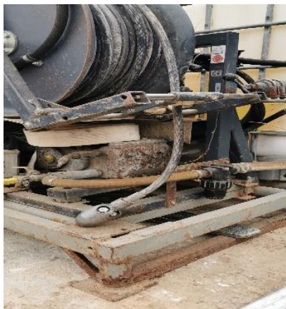
Slika 3: Naprava koler za odmaševanje kanalizacijskih cevi
